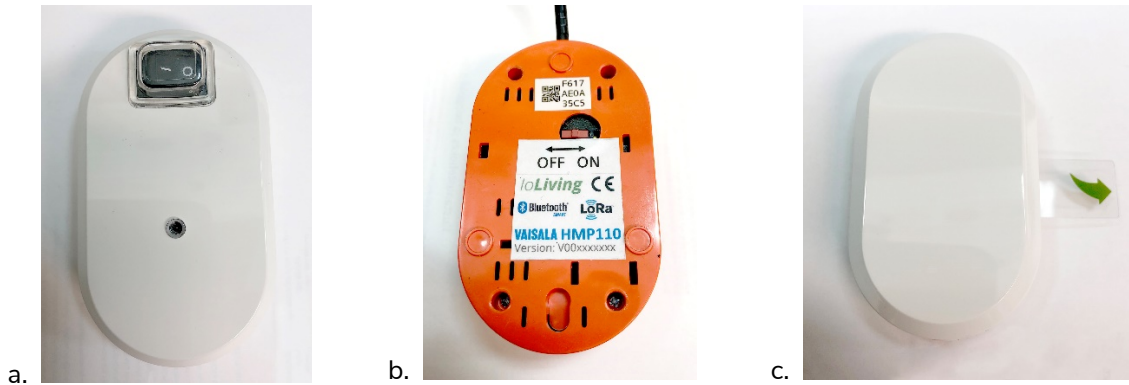
Kuva 1. Laitteen virtakytkin voi olla (a) keinukytkin, (b) liukukytkin tai laitteessa voi olla (c) pariston suojaliuska paikoillaan, joka poistetaan vetämällä nuolen suuntaan.
